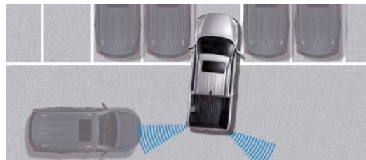
RCTA - system monitorowania ruchu za pojazdem
